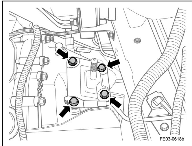
5. 拆卸变速器支架固定螺栓、螺母，移开搭铁线。
