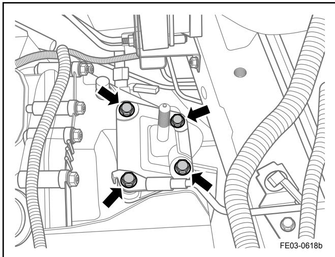
2. 安装搭铁线, 紧固变速器支架固定螺栓、螺母。
