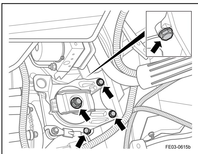
3. 安装变速器隔震垫, 紧固固定螺栓、螺母。
